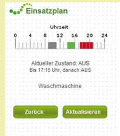
Einsatzplan eines Hausgerätes mit den verschiedenen Zuständen Automatik ein (grau), manuell ein (grün) und manuell aus (rot) auf dem Display des BEMIs.
