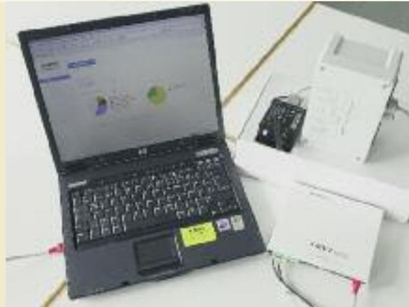
Mit dem System Energiebutler kann der Kunde entweder per Computer den Stromverbrauch seines Hauses automatisch an einen variablen Strompreis anpassen oder von Hand bestimmen, wann welcher Verbraucher ans Netz gehen darf.
