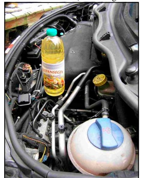
Links neben der Rapsölflasche befindet sich die elektronische Steuerung
