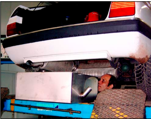
Der neue 70-Liter Pflanzenöltank wird unter dem Kofferraum montiert
