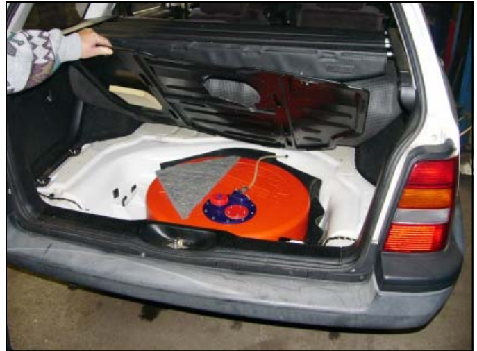
Dieser neue kleine Dieseltank in der Ersatzradmulde für die Kaltstartphase wird zukünftig wohl nur noch selten betankt
