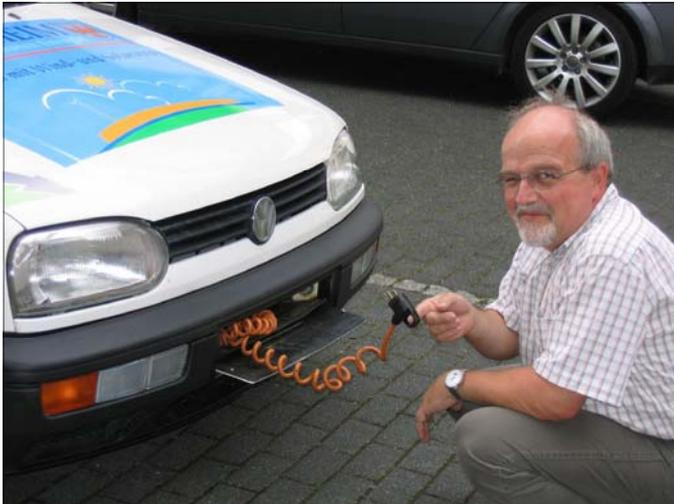
Strom laden ist leicht: Wolfgang Brüchert beim Hervorziehen des Ladekabels aus dem Versteck hinter dem vorderen Nummernschild des getesteten Elektrogolf
