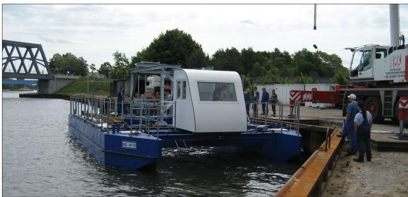
Probewässerung des Versuchsträgers in Genthin. Das fahrbare Kraftwerk mit 2 Pontons hat nur 70 cm Tiefgang.
