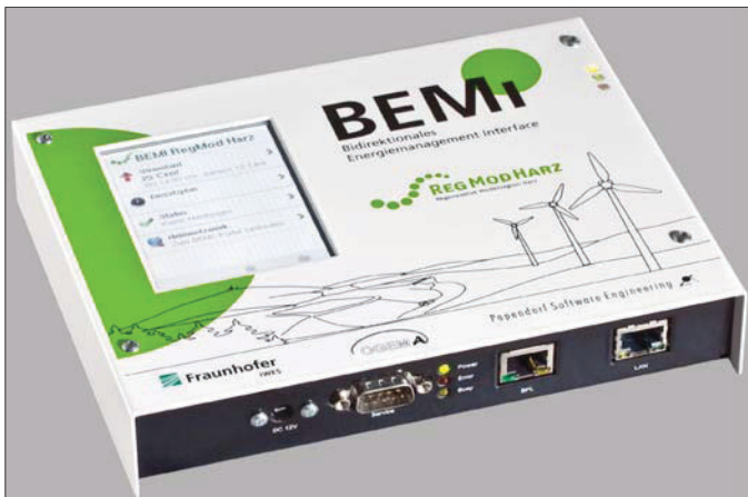
Das „Bemi“ (bidirektionales Energie Management Interface) informiert einsparungs-interessierte Verbraucher über Energieangebot und variable Tarife
